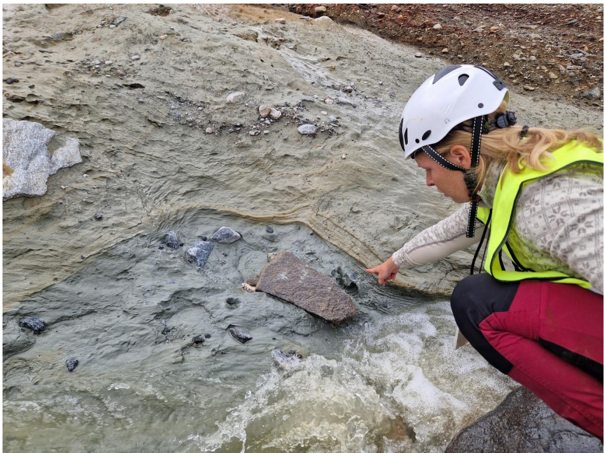
Figur 20. Leirholdige men relativt faste masser i skredbanen for skred 4 ved Langevegen 81.
