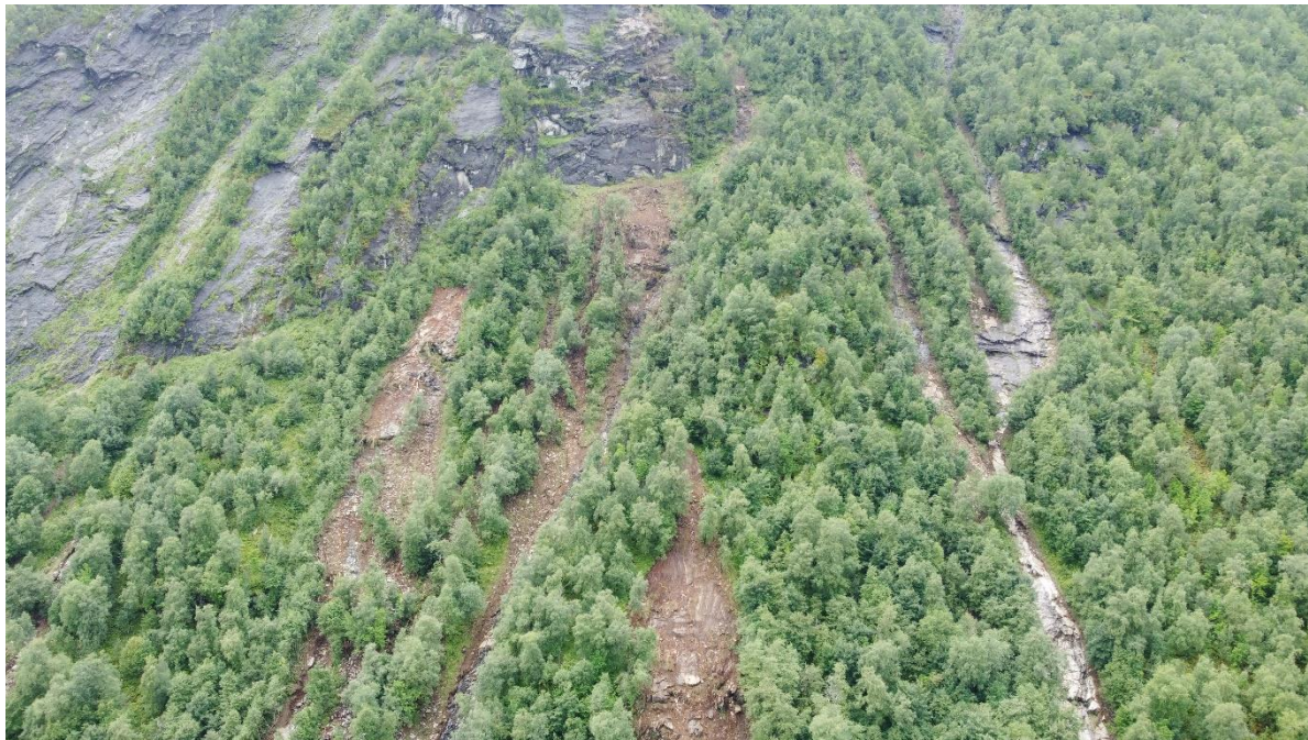
Figur 17. Løsneområder i toppen av skred 4 fra vinkel 2, under Anderskardshaugen (631 moh.). Løsneområdene er tydelige under berget ca. 600 moh. På enkelte punkter kan det se ut som det har løsnet torv, stein og jordmasser også over bergpartiet. Det kan også se ut som det har løsnet masser over venstre del av bildet som ikke har endt i skredet (4) som nådde ned til veien.
